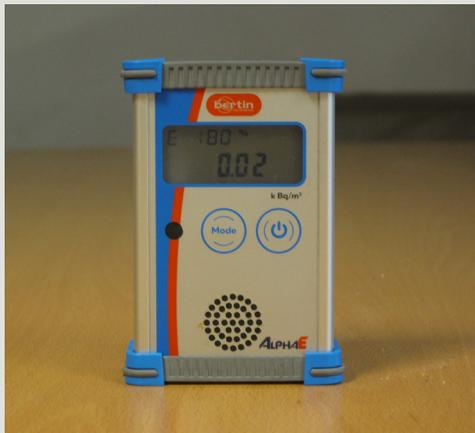
Bild 4: Radon-Messgerät
