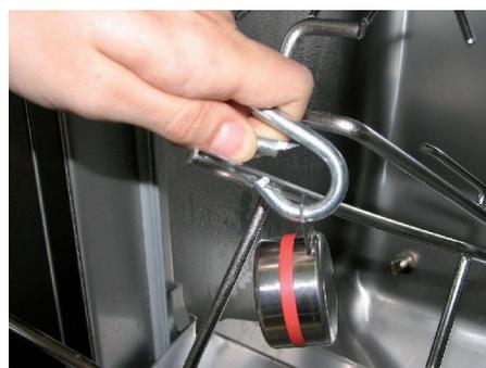
Abb. 2: Befestigung eines Datenloggers
